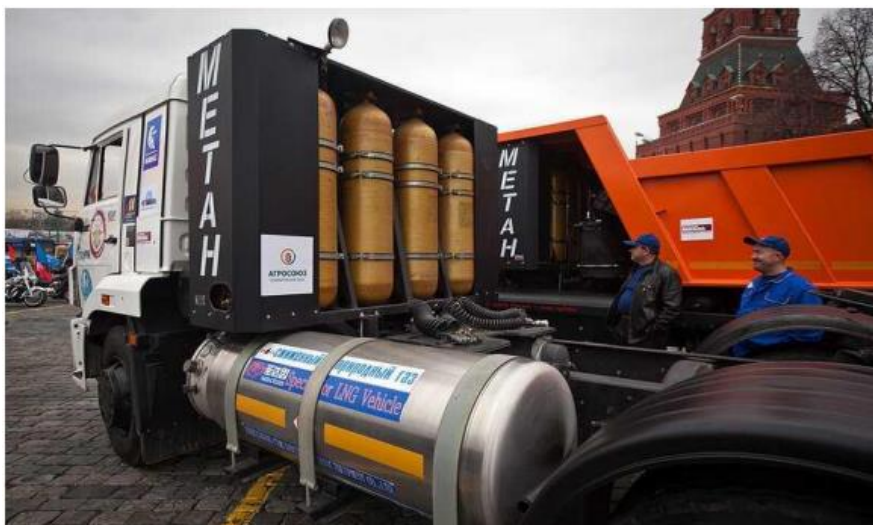
2.4 – сурет - Дизельді қозғалтқышы бар автомобильдердің газбен жұмыс істеуіне арналған отынмен қоректендірудің газдизельді жүйесінің орыны
